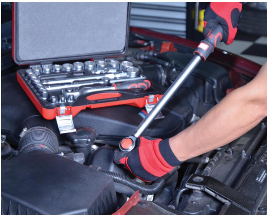
Данный инструмент используется для затягивания болтов и гаек на резьбовых соединениях, когда необходимо дозированное усилие затяжки. Рукоять ключа находится в его основании и вращается реверсивно. Вверху рукояти расположена основная шкала, на нижней части — дополнительная, с обозначениями от 0 до 10. Инструмент имеет высокую точность настройки и обеспечивает плавное затягивание гаек.
