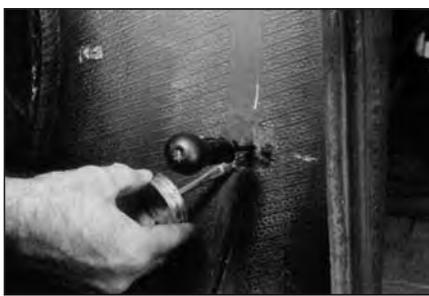
**14** Нанесите клей для химической вулканизации №760 на обработанную поверхность. Дайте клею примерно 3-4 минуты для того, чтобы он полностью высох. При ремонте камерной покрышки обработайте область до синтетических нитей корда, нанесите на нее 2 слоя клея. При работе в помещении с высокой влажностью или низкой температурой необходимо увеличить время высыхания клея.
