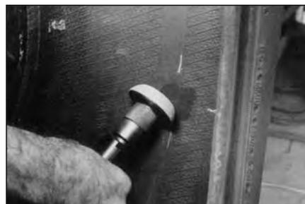
**9** Обработайте отмеченную область мелкозернистой абразивной полусферой. Скорость вращения дрели при обработке не должна превышать 4000 об/мин. При обработке внутренней поверхности шины старайтесь не задеть нити корда. При работе необходимо использовать защитные очки №S918.
