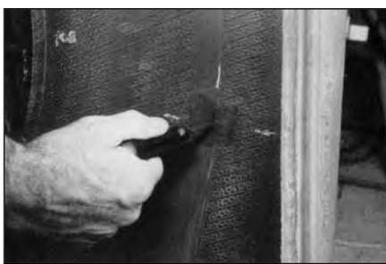
**13** Нанесите клей для химической вулканизации №760 внутрь прокола по всей его длине с помощью спирального шила, поворачивая шило по часовой стрелке. Повторите эту процедуру от 3 до 5 раз. Оставьте шило в проколе до тех пор, пока не перейдете к выполнению пункта 16 данной инструкции.
