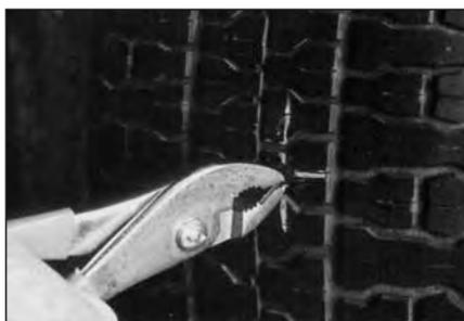
**17** Зажмите плоскогубцами металлический держатель с внешней стороны покрышки и вытяните ножку грибка. Если металлический держатель отделится от ножки, когда ножка грибка выйдет из прокола, зажмите ее плоскогубцами и тяните до тех пор, пока подложка не коснется поверхности покрышки изнутри.
