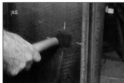
**12** Очистите пылесосом №S999 обработанную область для удаления металлической стружки, мелких частиц резины и резиновой пыли.
